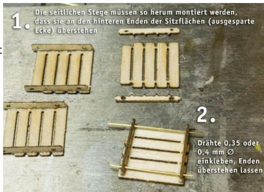
rechtwinklig zueinander sind (3.). Nach Montage des zweiten Seitenteils und des Verbindungsdrahtes muss nur noch die Lehne verklebt werden (4.). Dann werden die überstehenden Drähte abgeknipst und die farbliche Behandlung kann erfolgen (macht man das bereits vorher, besteht die Gefahr, dass die Bohrungen zuschmieren).
