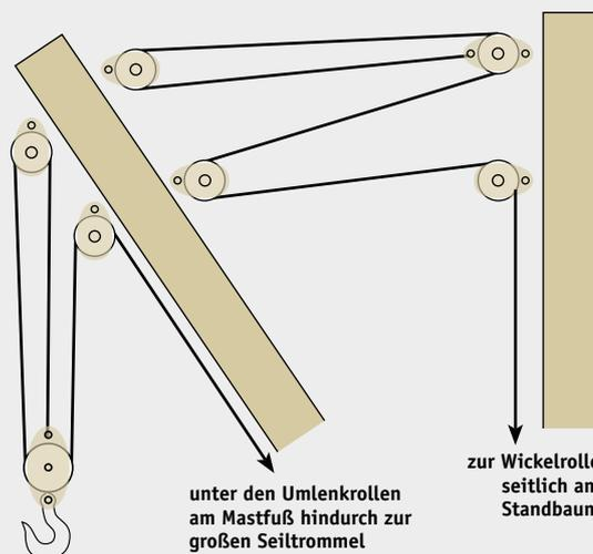
fixiert wird. Dann kann man durch Drehen der Seiltrommel das Seil für den Ausleger aufwickeln. Durch die Flaschenzugwirkung reicht der Reibungswiderstand der Trommelachse in der Regel aus, um den Ausleger in Position zu halten.
