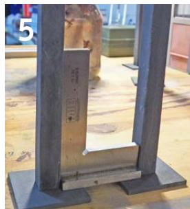
Die am besten gelungenen Betonpfeiler kommen natürlich nach außen; beim Verkleben mit der Bodenplatte ist auf rechten Winkel achten (5)!
