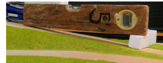
Messung der Steigung mit Wasserwaage und beschneidbarem Styrodurklötz. Das (bemerkenswerte) Ergebnis steht im Text.
