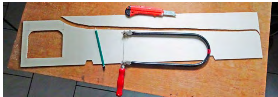
Zum Anzeichnen der Rückwand des Fiddleyards wurde die im Bild oben sichtbare Sperrholzplatte nach dem Ausschneiden der zwei kleinen Trapeze (s. kleines Bild unten) an die rechte Außenwand der Anlage geschraubt, die beiden Trapeze ebenfalls, jedoch zusätzlich geleimt, denn sie sollen dort für immer bleiben. Nach dem Anzeichnen der Form konnte die Platte wieder abgeschraubt und passend zugesägt werden. Das Cuttermesser liegt dort deshalb, weil durch die Schnittlängenbegrenzung der Laubsäge in der Mitte des Schnittes ein Stück übrig blieb. Dort war ein Messerschnitt nötig.
